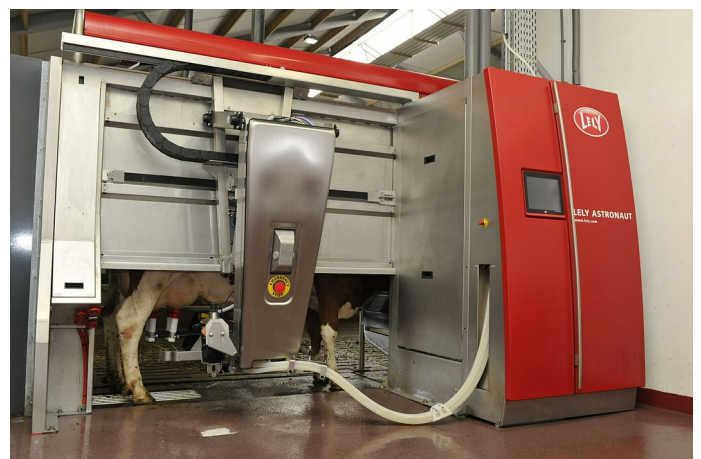
Ein Melk-Roboter des Fabrikats Lely
